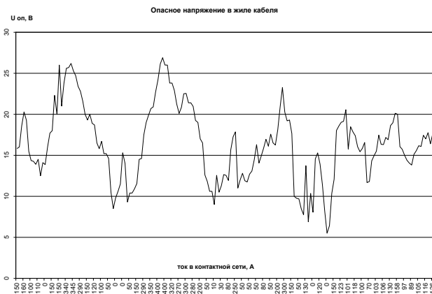
Диаграмма 6 – Опасное напряжение в жиле кабеля
