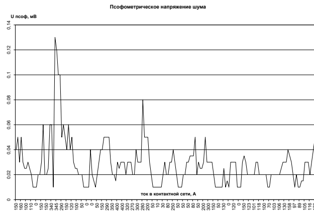
Диаграмма 5 – Псофометрическое напряжение шума в кабеле, измеренное в полосе 0,3 – 3,4 кГц.
